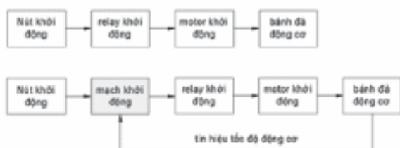
Hình 8. Sơ đồ bố trí mạch khởi động trước và sau khi lắp mạch
