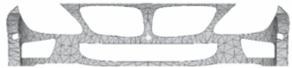
Hình 1. Mô hình BDS I cổng phun trong Moldflow
