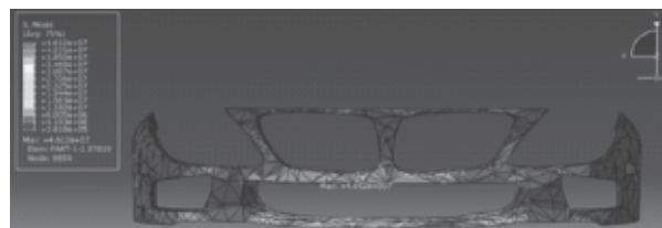
Hình 3. Phân bố ứng suất ứng với vận tốc 5 \text{ m/s}
