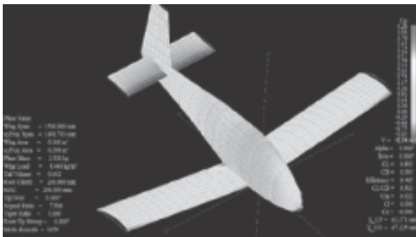
b. Hệ số phân bố áp suất Hình 4. Phân bố lực nâng và áp suất
