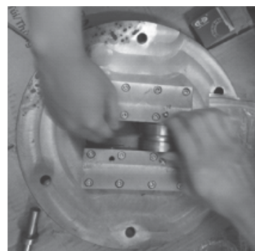
Hình 6. Hai gối đỡ cố định trục con lăn
