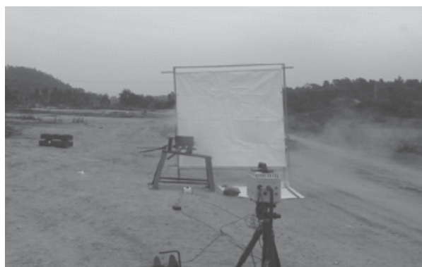
Hình 2. Hình ảnh bắn đo sơ tốc đạn ống lồng 23mm
