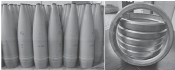
Hình 1. Đầu đạn pháo và phôi đai dẫn hiện đang sử dụng trong Quân đội ta
