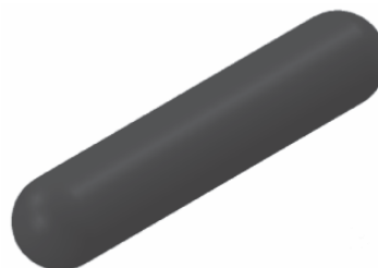
Hình 3. Ống PVC tạo sức nổi
