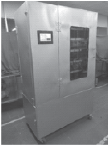
Hình 2. Máy sấy đa năng được chế tạo
