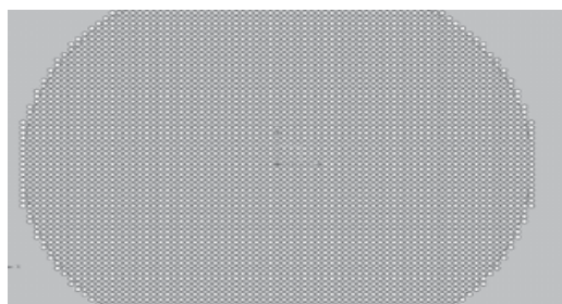
Hình 6. Mô phỏng hình dạng rãnh đùn và các ô vuông loại 600 cell/inch 2
