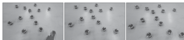
Hình 4. Ảnh chụp thử nghiệm chuyển từ normal mode sang idle mode. Đèn led màu xanh cho biết robot đang ở normal mode trong khi đèn led màu cam cho biết robot đang ở idle mode. Trái: người dùng chạm vào một robot bất kỳ trong bầy để khởi động idle mode. Giữa: Thông báo "chờ" được lan truyền khắp nơi trong bầy. Phải: Toàn bộ bầy đàn chuyển sang idle mode.
