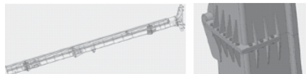
Hình 8. Kết cấu của cần hộp và liên kết bulong ở khớp bản lề
