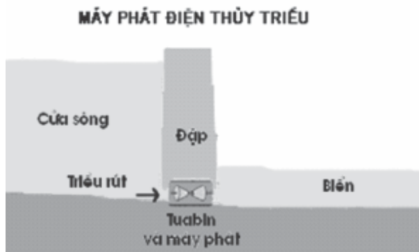
Hình 2. Nguyên lý nhà máy điện thủy triều
