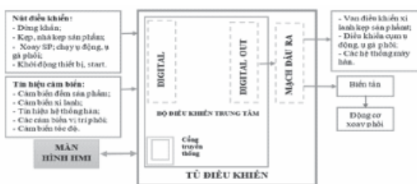
Hình 5. Sơ đồ chức năng tủ điều khiển
