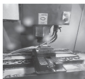
Hình 10. Gia công sản phẩm trên máy phay Xmill 640
