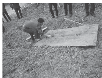
Hình 4. Hàn nổ chế tạo tấm vật liệu bimetal dạng lớp nhôm-thép kích thước lớn
